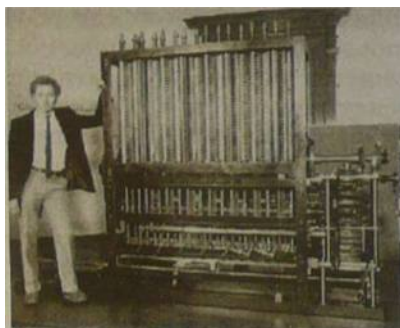
Рис. 1.5. Аналитическая машина Бэббиджа (реконструкция)
